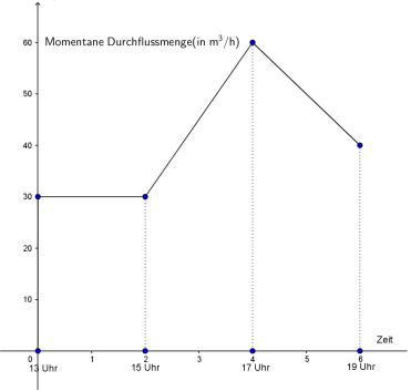
Die zwischen 13 Uhr und 19 Uhr geförderte Menge Erdöl kann wird durch den Flächeninhalt dargestellt.
