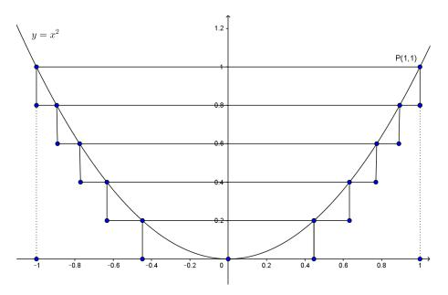
Das Paraboloid wird näherungsweise durch den äusseren Treppenkörper ersetzt, der aus n zylindrischen Scheiben der Höhe  $h = \frac{1}{n}$  besteht. Zu den n Scheiben gehören dann die
