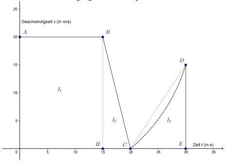
Anhand des abgebildeten Geschwindigkeits-Zeit-Diagramms kann die im Zeitintervall von 0s bis 20s die zurückgelegte Strecke bestimmt werden.
