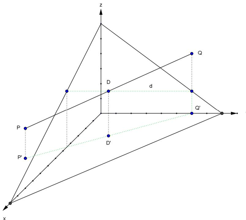
geometrisch: Lege eine Hilfsebene senkrecht zur Grundrissebene durch  $g$ . Diese schneidet die gegebene Ebene in einer Geraden  $d$ .  $d$  und  $g$  schneiden sich im gesuchten Durchstoßpunkt  $D$ .
