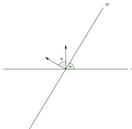
Unter dem Schnittwinkel  $\varphi$  zweier nicht paralleler Ebenen  $\varepsilon_1$  und  $\varepsilon_2$  versteht man den nicht stumpfen Winkel, der von zwei sich schneidenden Geraden  $g_1 \in \varepsilon_1$  und  $g_2 \in \varepsilon_2$  gebildet wird, die auf der Schnittgeraden  $s$  senkrecht stehen. Da die Normalenvektoren der beiden Ebenen den gleichen Winkel  $\varphi$  oder dessen Ergänzung auf  $180^\circ$  einschliessen, gilt gemäss Definition des Skalarprodukts:
