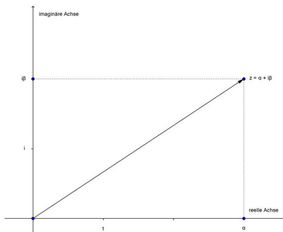
$\bar{z} = \alpha - \beta i$  heisst die zu  $z = \alpha + \beta i$  konjugiert komplexe Zahl (conjugere, verbinden). Die zu  $z$  und  $\bar{z}$  gehörigen Punkte liegen symmetrisch zur reellen Achse.
