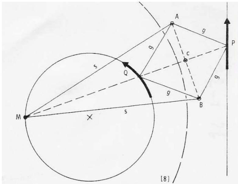
In der Abbildung sind MA und MB Stangen, die mit der Gelenkraute PAQB verbunden sind. Bewegt sich P auf einer Geraden, dann beschreibt Q eine kreisförmige Bewegung (und umgekehrt).
